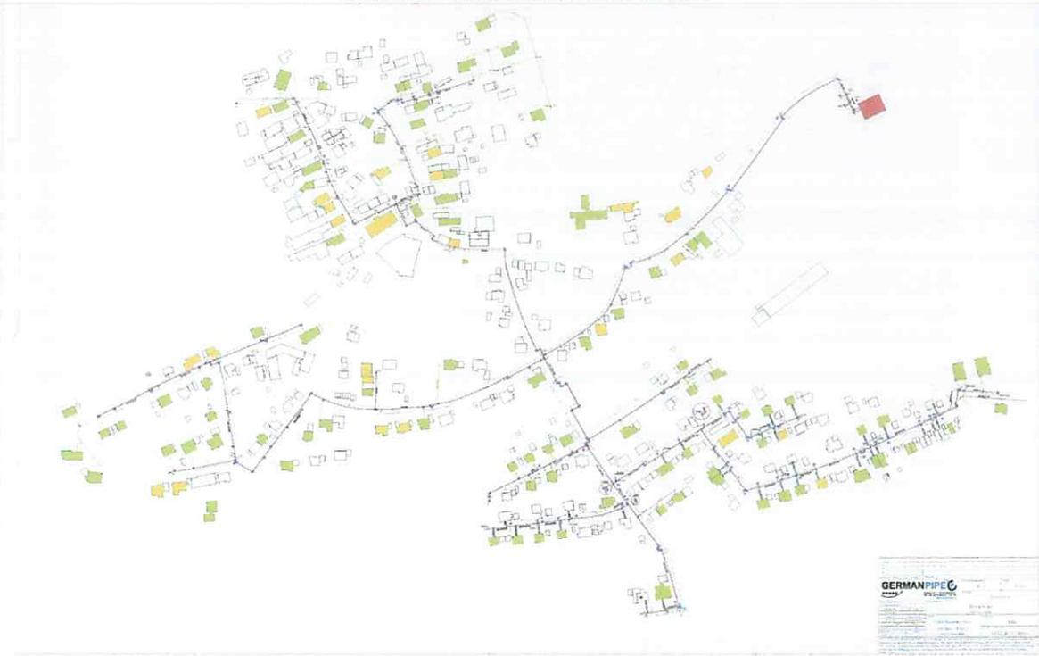
Grün-Vollanschluss; Gelb-Teilanschluss; Rot- Biomassekraftwerk.
